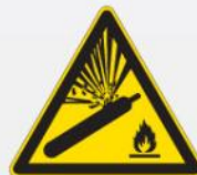
Pericolo bombola pressurizzata W029
