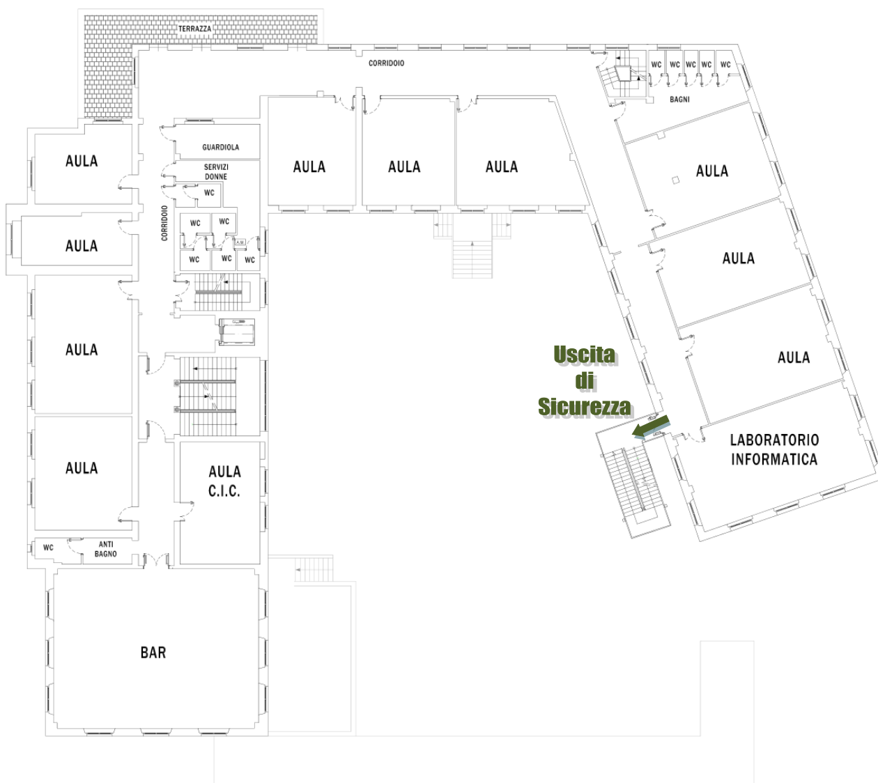
Schema planimetrico del piano primo con indicazione delle uscite di sicurezza
