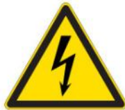
Pericolo elettricità W012
